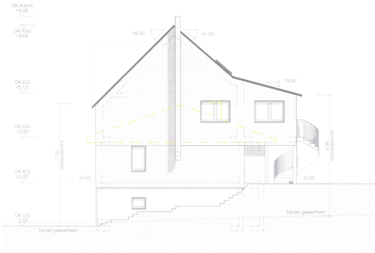
Abbildung 13: Westansicht Aufstockung mit Höhenvermessung und illustriertem Abbruch, Gewachsenem Terrain gem. Reglement und effektivem Terrain Bestand im Mst. 1:130 86
